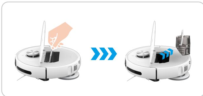
2. Sbloccare la fibbia sul lato della scatola della polvere, aprire il coperchio della scatola della polvere e versare fuori la spazzatura al suo interno.
