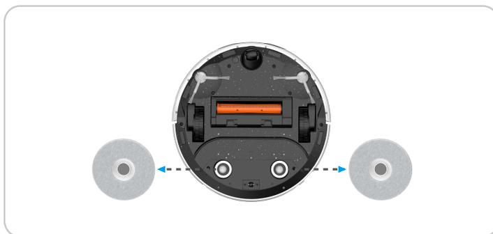
3. Rimuovi il vecchio panno per mop dalla struttura del mop e sostituiscilo con uno nuovo, quindi rimetti la struttura del mop sul Robot.
